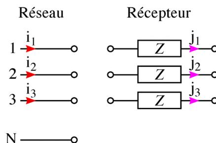
Le réseau et le récepteur peuvent se relier de deux façons différentes : en étoile ou en triangle.
